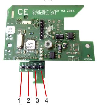
FLEXI Repeater AP-flach im Gehäuse mit Steckklemme 4-polig
